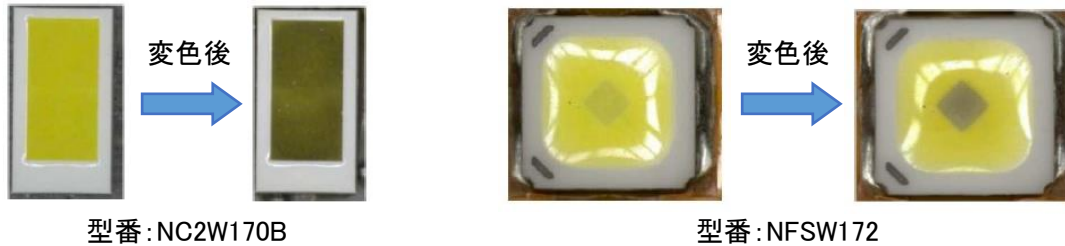
図 6. VOC による LED の変色例
