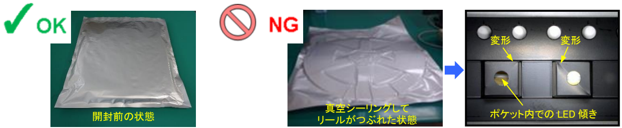
図 2. 真空保管とエンボスキャリアテープの変形
